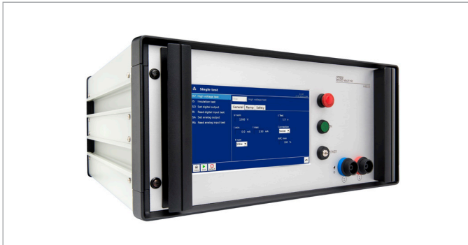
Hochspannungsprüfgerät HA 1885G Einschub 19" / 5 HE im Gehäuse
